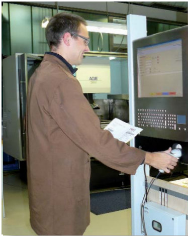
Bild 2: Die Einführung der neuen MDE sieht man in Mühlacker als optimale Kontrolle für die AV. Für die Mitarbeiter hat sich die Eingabe wesentlich erleichtert. Statt pro Maschine ein Terminal, wird mit zentralen Terminals für alle Maschinen gearbeitet
