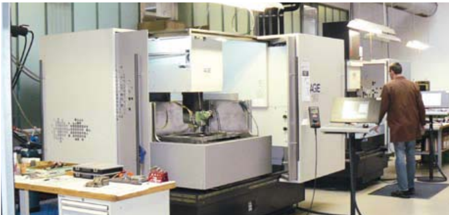
Die Vorteile der MDE werden bei Dettinger vor allem über die Erodiermaschinen sichtbar, die meist ja auch mannlos betrieben werden. So entfällt ein zeitaufwändiges Nachtragen der Zeiten.
